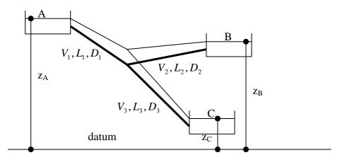
Unknowns:  $V_1, V_2, V_3$
